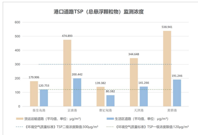
图2-13 (c) 各港口运输区道路与生活道路TSP监测数据对比
